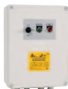
Le coffret de démarrage CD 590/650 - EVOL est équipé d'un relais qui permet au flotteur alarme d'enclencher et de déclencher la pompe en cas de dysfonctionnement du flotteur de marche/arrêt.
